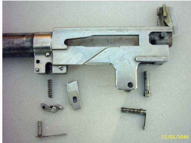
En la fotografía, la parte móvil (cañón y bloque de cierre) donde se puede apreciar el sistema de extracción, el extractor (11), la palanca (12) y el resorte (13).
