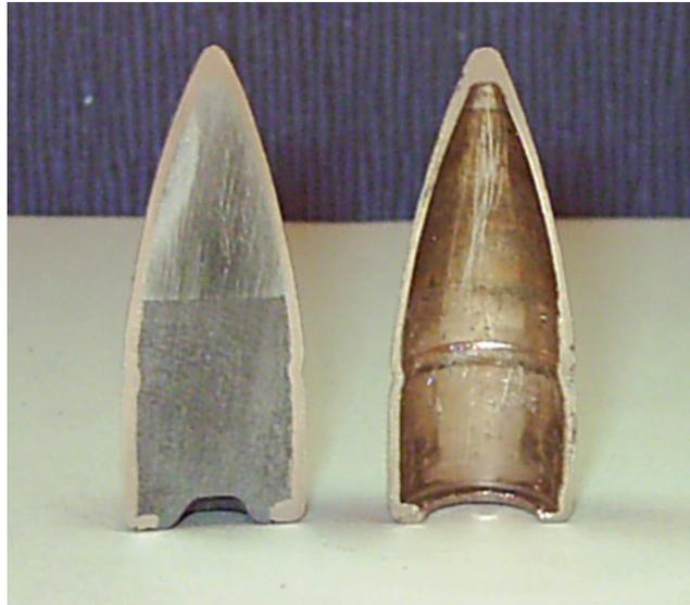
En la foto una bala seccionada mostrando, sobre la derecha, el interior de la camisa y sobre la izquierda, la camisa conteniendo los dos núcleos mencionados.
