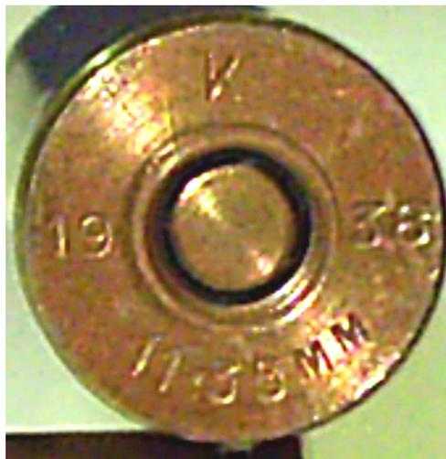
En la foto una imagen del grabado del culote de una vaina fabricada por la Kynoch, en este caso del año 1938. Pueden apreciar el tipo de engastado o crimp que se le realizó sobre la junta anular entre cápsula iniciadora y vaina.
